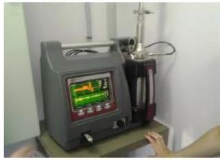
15 fracciones (6 nm – 10µm)
